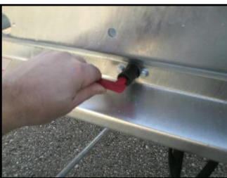
Bild 5: Hauptschalter auf EIN gestellt
