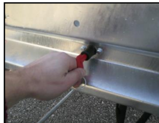
Bild 8: Hauptschalter auf AUS gestellt
